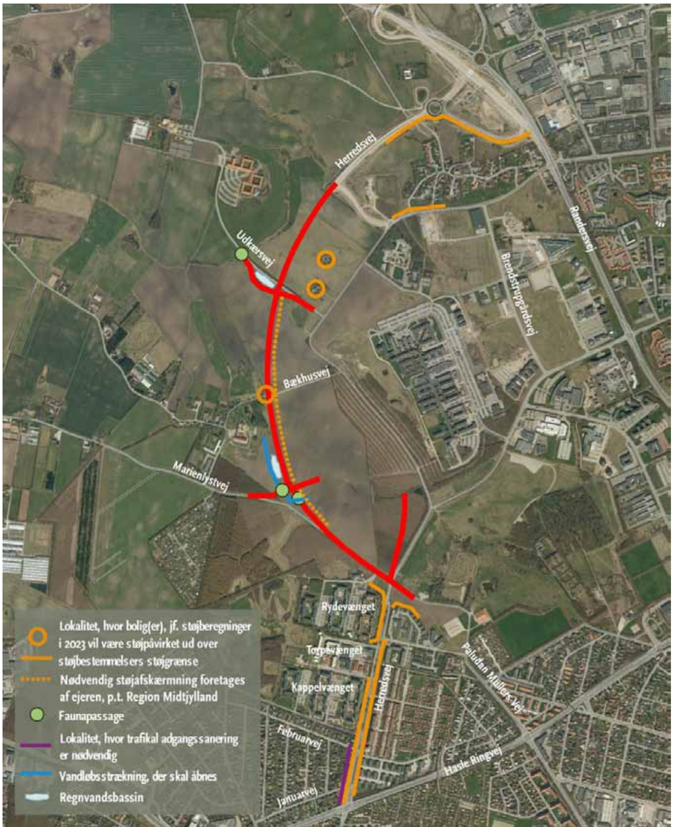
Figur 1 Afværgeforanstaltninger ved forlægning af Herredsvej.
