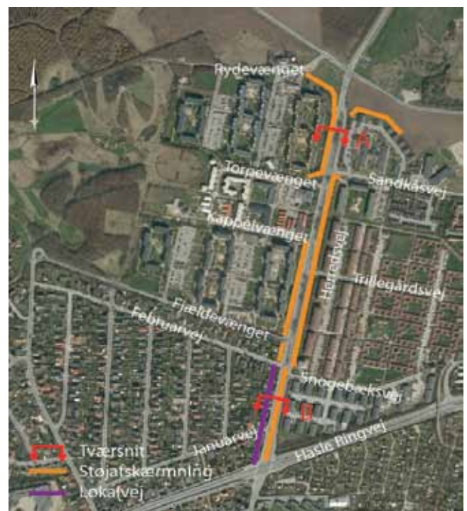
Figur 9 Placering af støjafskærmning langs eksisterende Herredsvej mellem Marienlystvej og Hasle Ringvej samt placering af snit.
