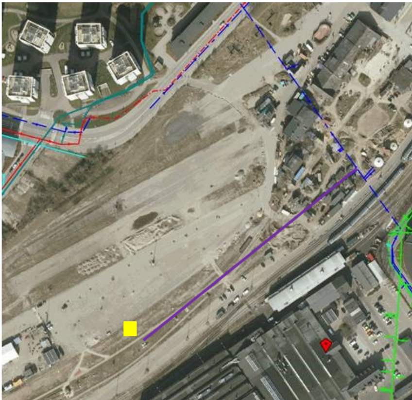
Figur 1: Pumpebrønd angivet med gul firkant tilsluttes internt regnvandssystem (illa linje) med tilslutning til Aarhus Vands regnvandsledning (blå linje)
