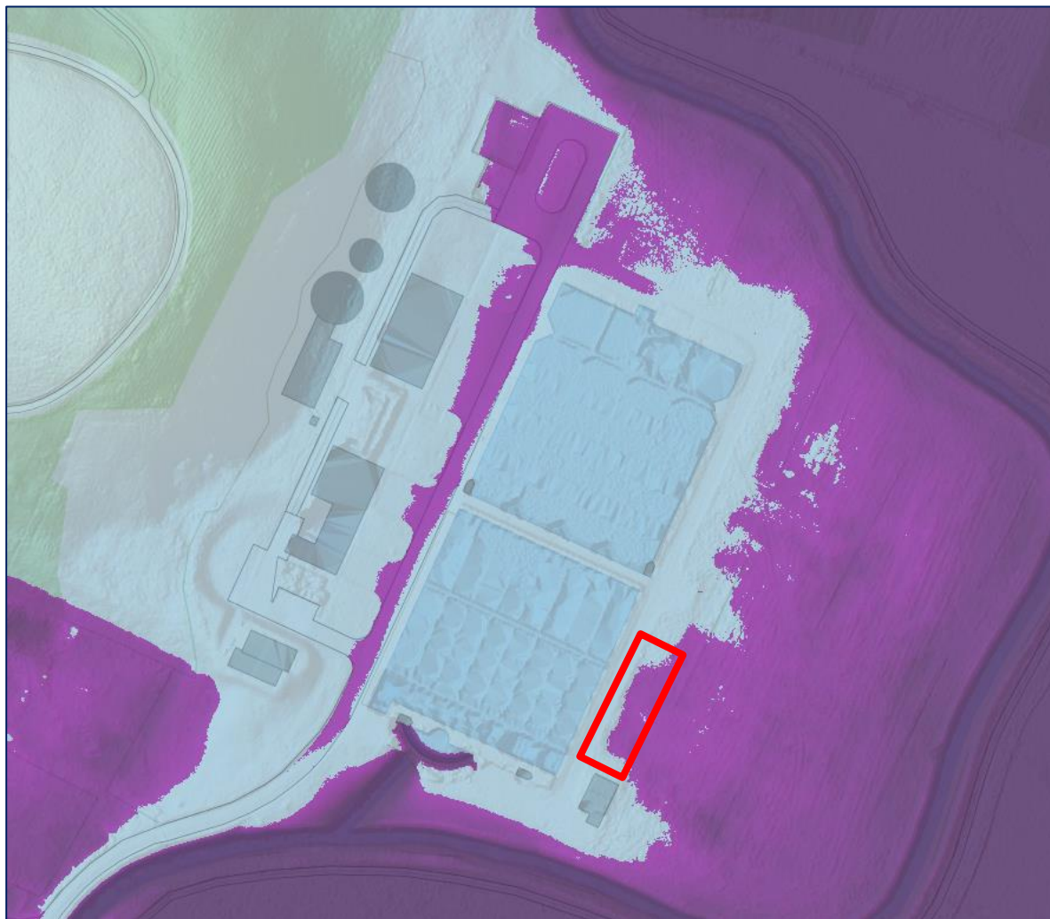
Figur 2 Oversvømmelseskort for 100 års stormflodshændelse. Placering af nyt anlæg er vist med rød firkant. Se i SCALGO LIVE .
