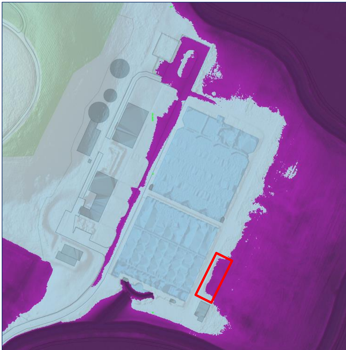
Figur 3 Oversvømmelseskort for 100 års vandføringshændelse i omkringliggende vandløb. Placering af nyt anlæg er vist med rød firkant. Se i SCALGO LIVE .
