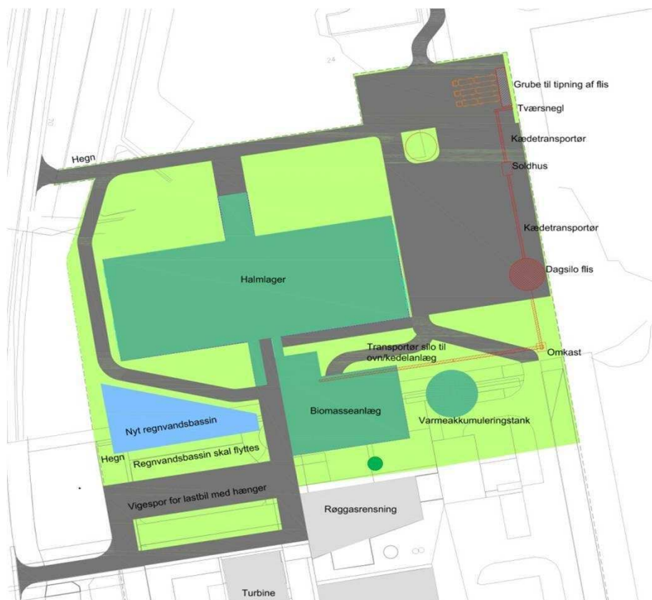
Figur 1 Bygningsmæssige udvidelser i forbindelse med der biomassefyrede kraftvarmeværk (kortet er kun en grov skitse. Et mere præcist kort er vist i afsnit 8.2 om spildevand)
