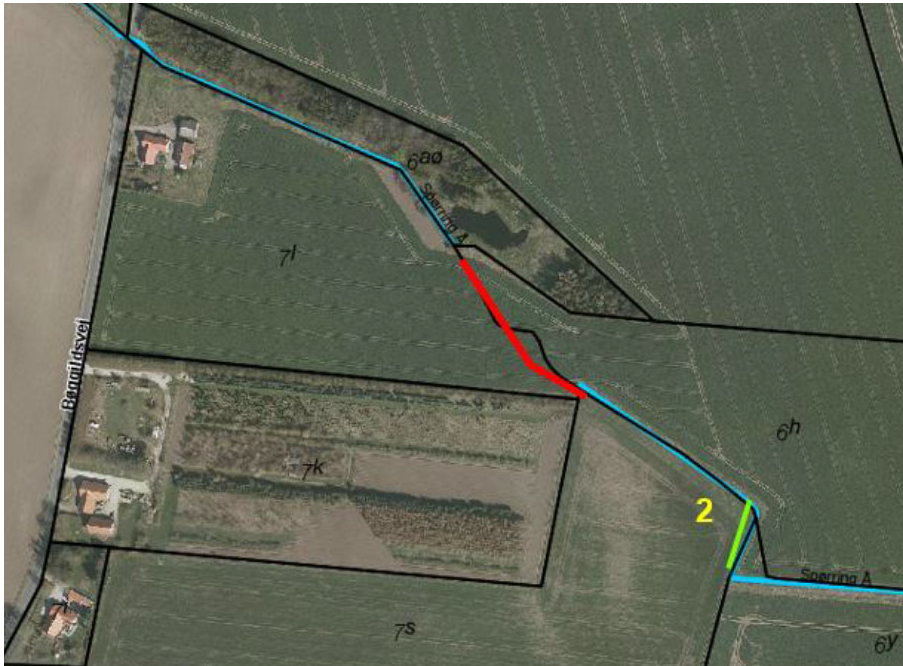
Figur 2: Oversigtskort over de nuværende forhold i projektområdet. De blå streger markerer det åbne forløb af Spørring Å, den røde streger markerer det rørlagte forløb af Spørring Å og de grønne streger markerer tilløb af hoveddræn (omtrentlig placering)
