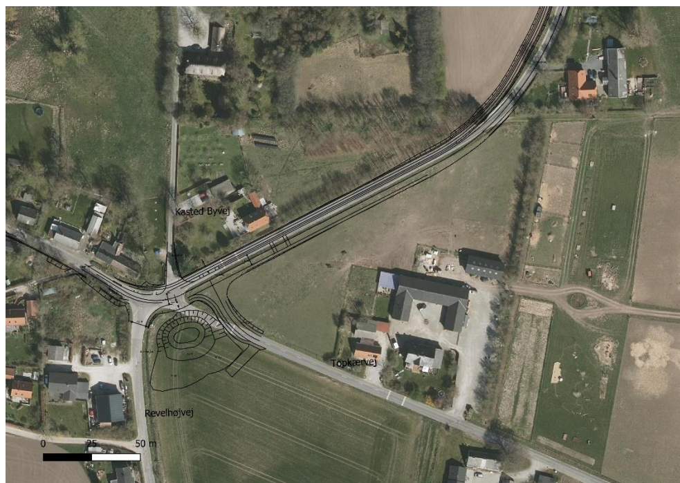
Figur 6-2 Placering af kommende regnvandsbassin.
