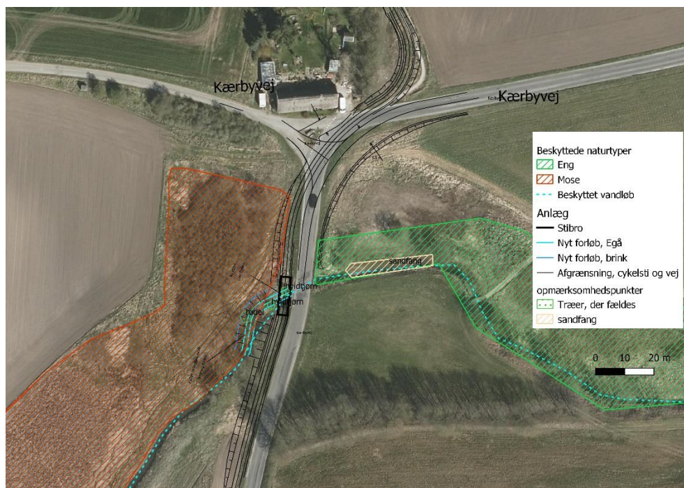
Figur 6-1 Projektkort for regulering af vandløb, etablering af cykelstibro og omlægning af vejen ved Egå.
