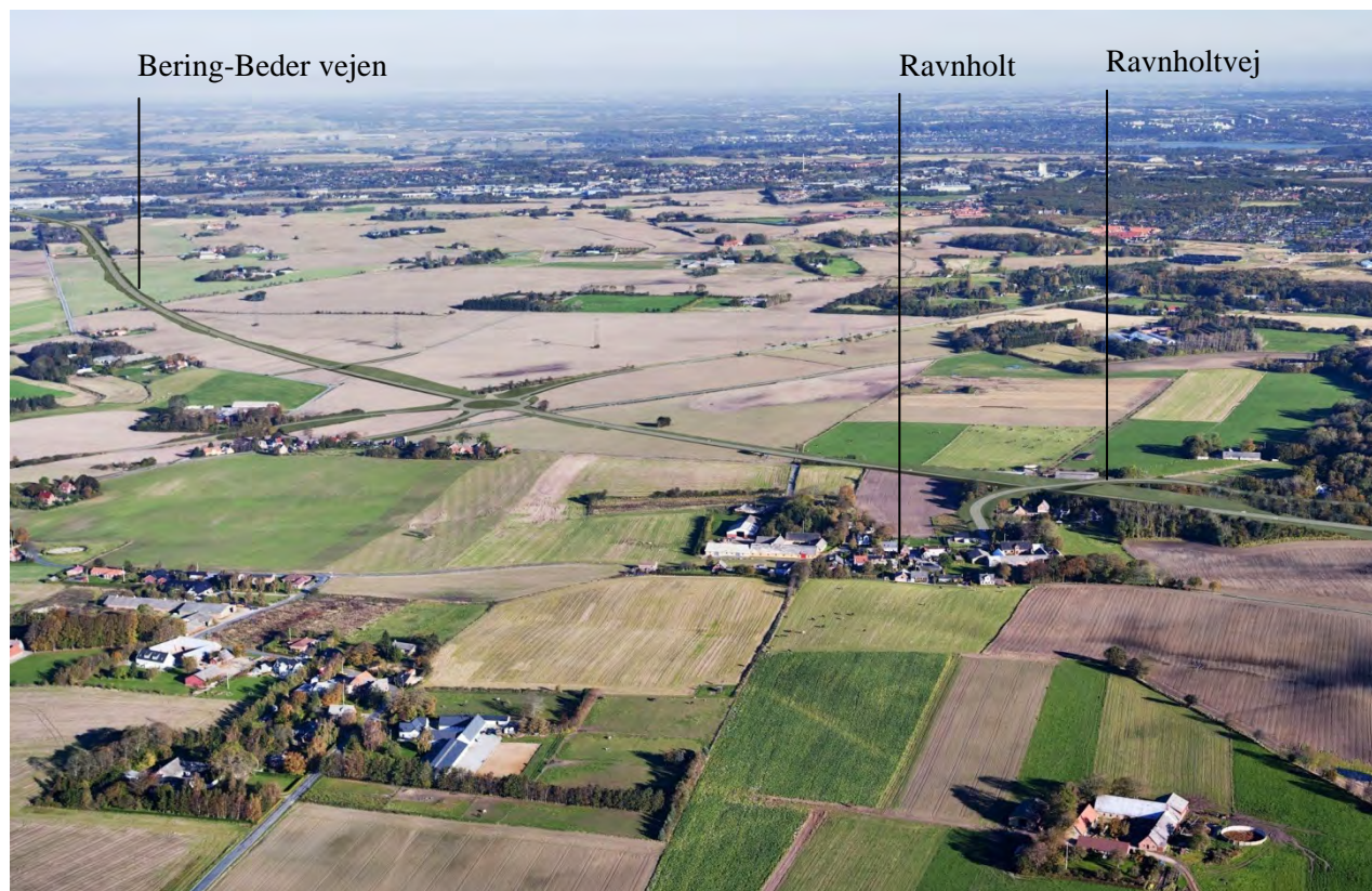
Figur 67 Luftvisualisering af passagen ved Ravnholt. Ravnholtvej føres over Bering-Beder vejen, som ligger i delvis afgravning. Luftvisualisering 17.
