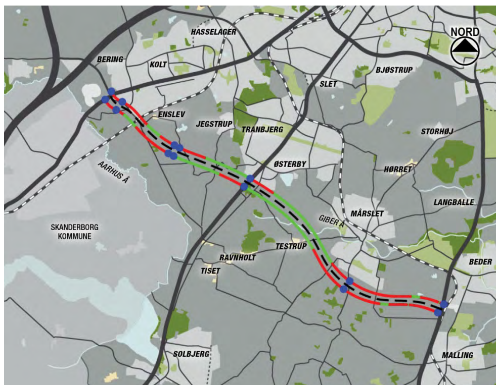
Figur 4.12 Overhalingssigt ved alternativ A. De grønne streger angiver strækninger med overhalingssigt.
