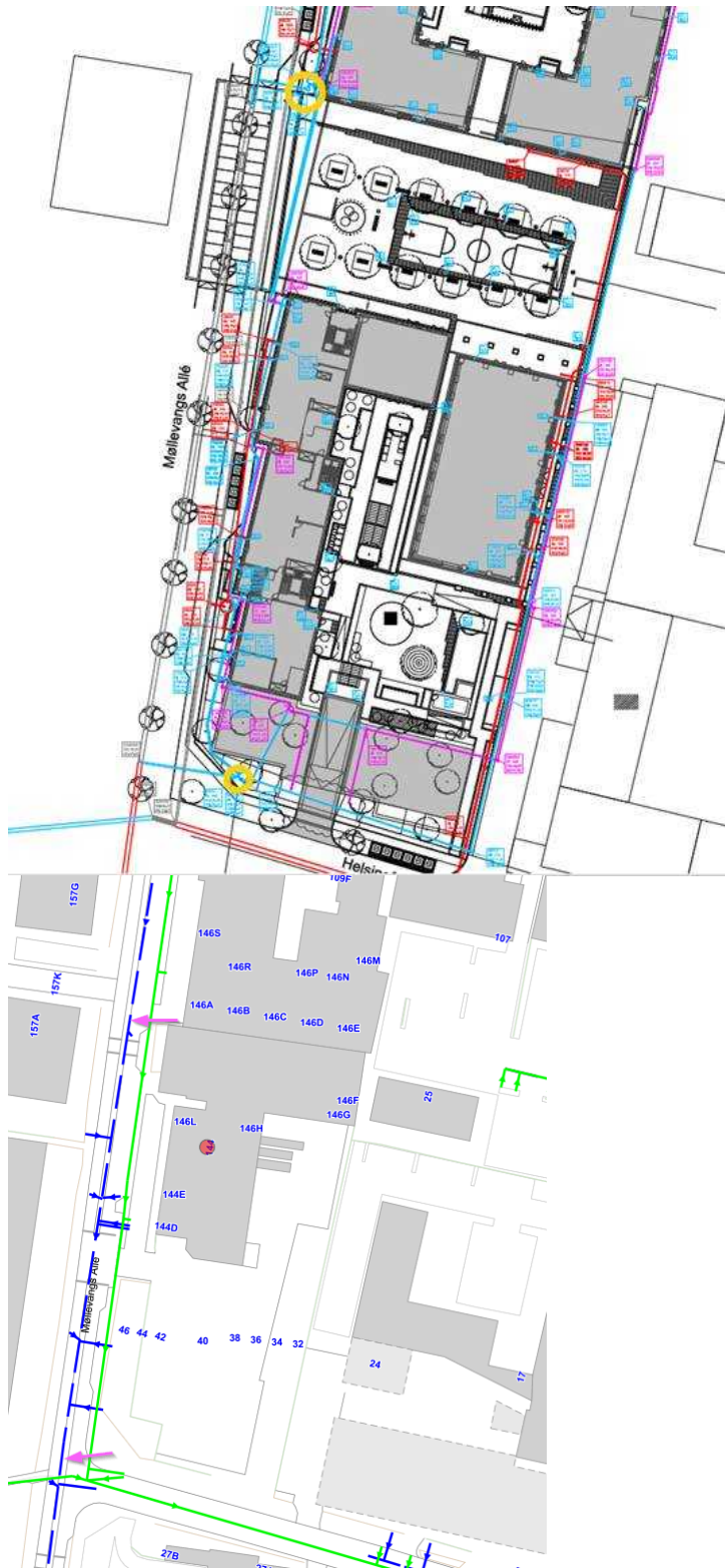
Figur 1: Oversigtskort over byggeriet. Indtrængende grundvand ledes til Aarhus Vands regnvandsledning i 2 tilslutningspunkter langs Møllevangs Allé (vist med gule cirkler og pink pile). Regnvandsledningen fører til Aarhus Å UDLØB PU64 (v/Ringgaden hvor den krydser Søren Frichs Vej) vist på figur 2.
