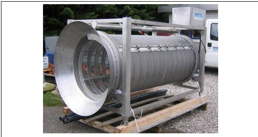
Figur 2.2 Eksempel på filterenhed til tromlefilter.
