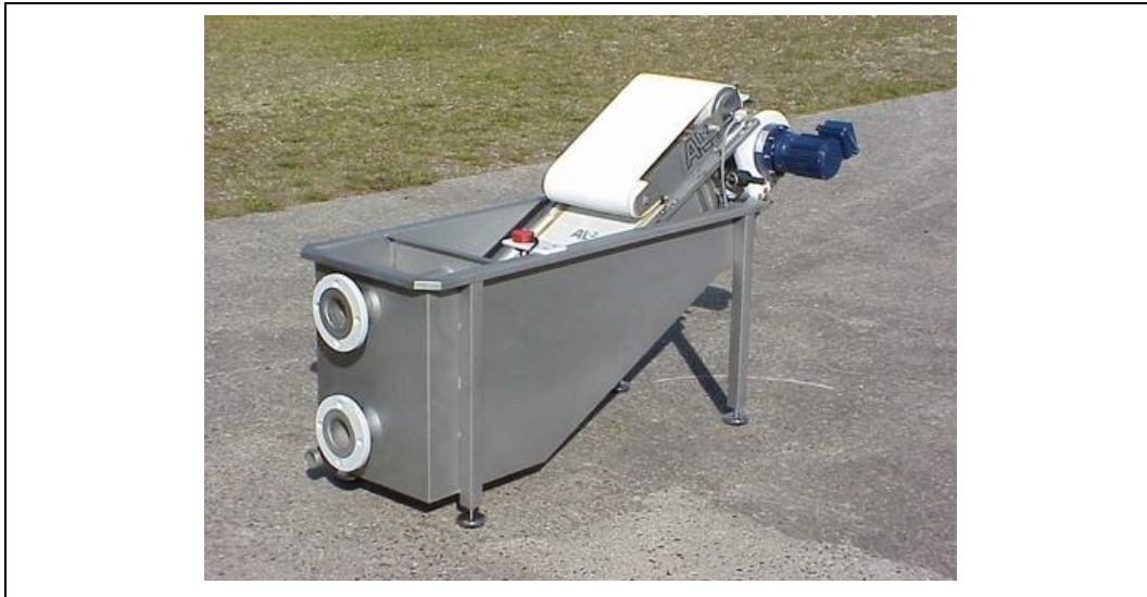
Figur 2.1 Eksempel på båndfilter monteret i rustfrit står kar.
