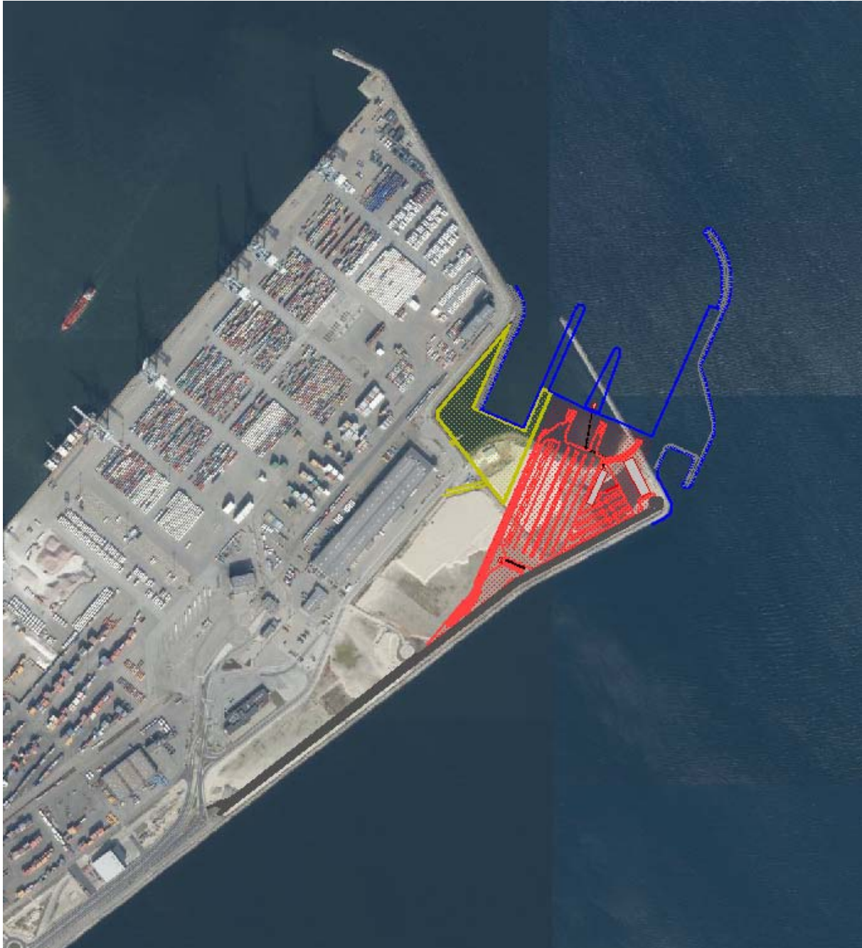
Placering af færgeterminal (rød), RO/RO-terminal (gul) og forlængelse af Østhavnsvej (mørk grå), Aarhus Havn. Blå linje angiver ny kystlinje i form af kajkant/færgeleje/mole.
