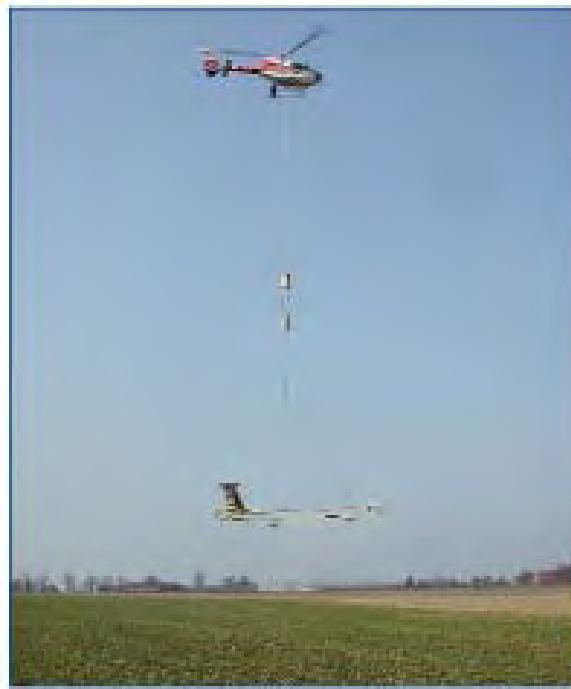
Figur 4.2.3. SkyTEM måling udført fra helikopter. Den transiente måling udføres på tilsvarende vis som en traditionel TEM måling; dog hænger udstyret i luften frem for at ligge på jorden.
