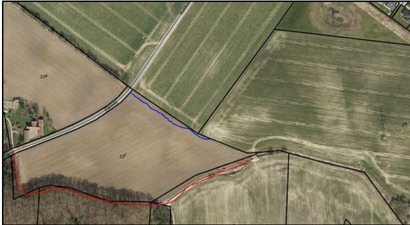
Figur 3: Eksisterende privat fællesvej (rød markering) og midlertidig byggepladsvej, der etableres med stabilgrus (ca. 140 m) (blå markering).
