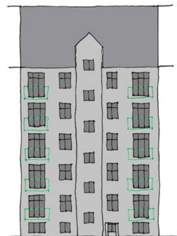
Altaner, Facadelængde på 13,6 meter
