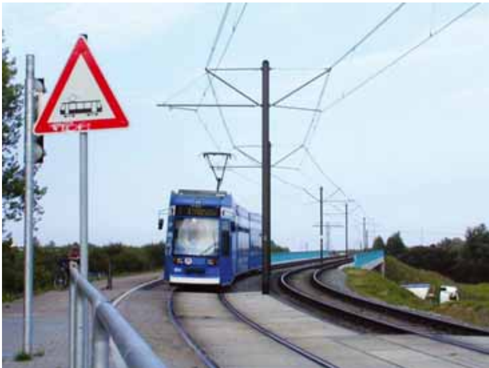
Figur 3-19 Centermaster med køreledninger med baretov nær Rostock, Tyskland.
