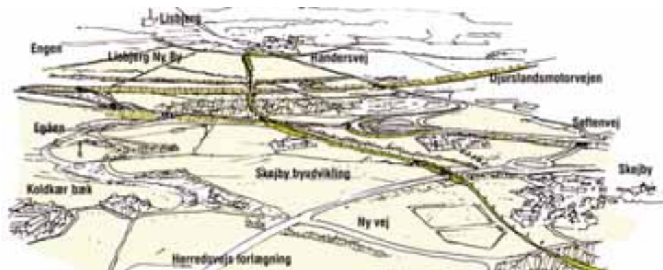
Figur 8-29 Vignet af letbanetracé ved Skejby og krydsning af Herredsvejs forlægning ude af niveau - alternativ 1.
