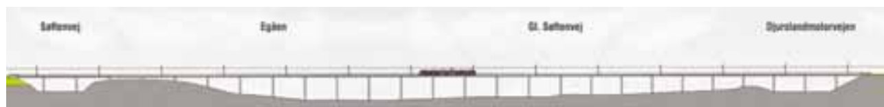
Figur 8-40 Principstalt for hovedforslagets variant 1, fuld brosløsning, over Egådalen.
