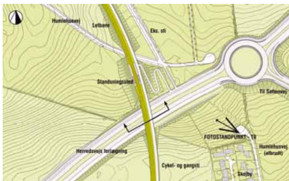
Figur 4-3 Planudsnit for alternativ 1 med krydsning af Herredsvejs forlægning ude af niveau samt angivelse af fotostandpunkt T9.
