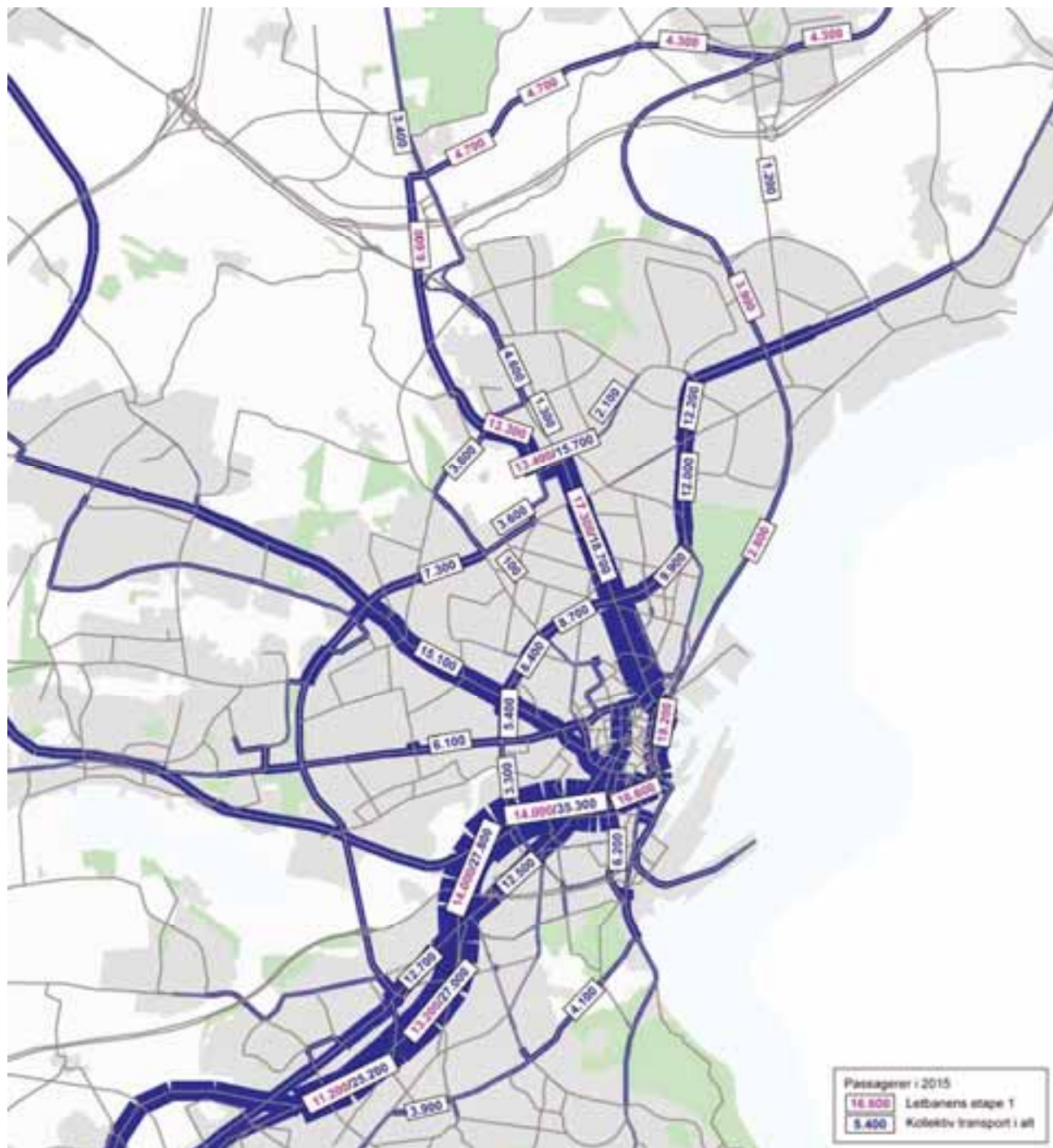
Figur 5-9 Passagerstrømme med kollektiv transport i et hverdagsdøgn ved etablering af letbanens etape 1. Det blå bånd viser antallet af passagerer med den kollektive trafik i alt (letbane, bus og tog). Med lilla tal er anført det antal passagerer, der alene benytter letbanen.
