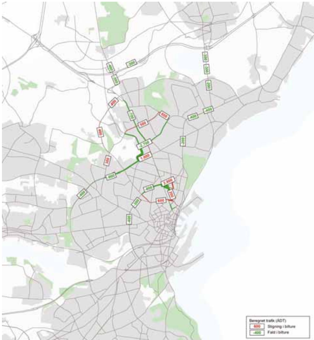
Figur 5-8 Ændringen i biltrafikken ved etablering af letbanens etape 1. De røde bånd viser, hvor antallet af bilture stiger, mens de grønne bånd viser, hvor antallet af bilture falder i forhold til 0-alternativet.
