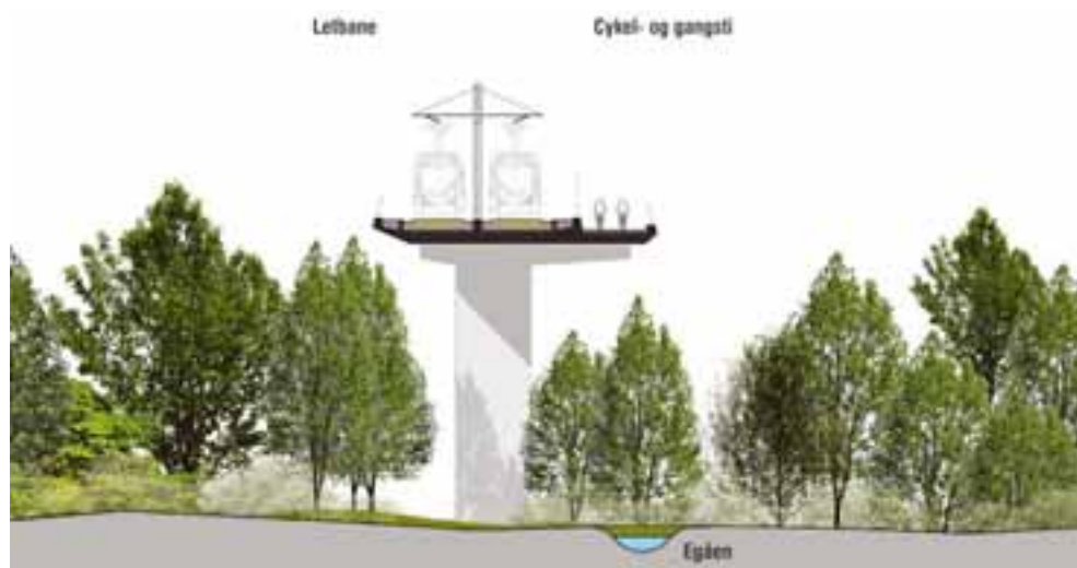
Figur 1-13 Principssnit for dalbro over Egådalen.
