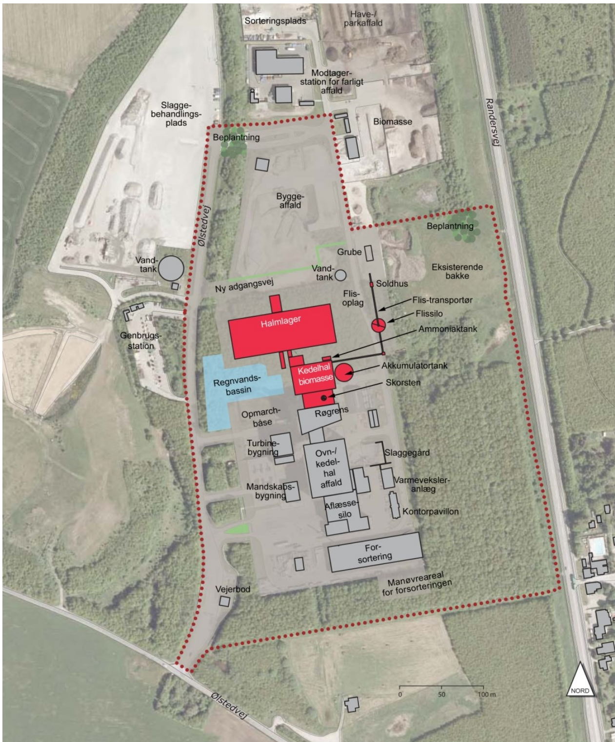
Areal omfattet af Lokalplan nr. 940. Illustrationsplan for udvidelsen af Affaldscenteret Aarhus med et biomassefyret kraftvarmeanlæg. Eksisterende bebyggelse er vist med gråt og planlagt bebyggelse med rødt.
