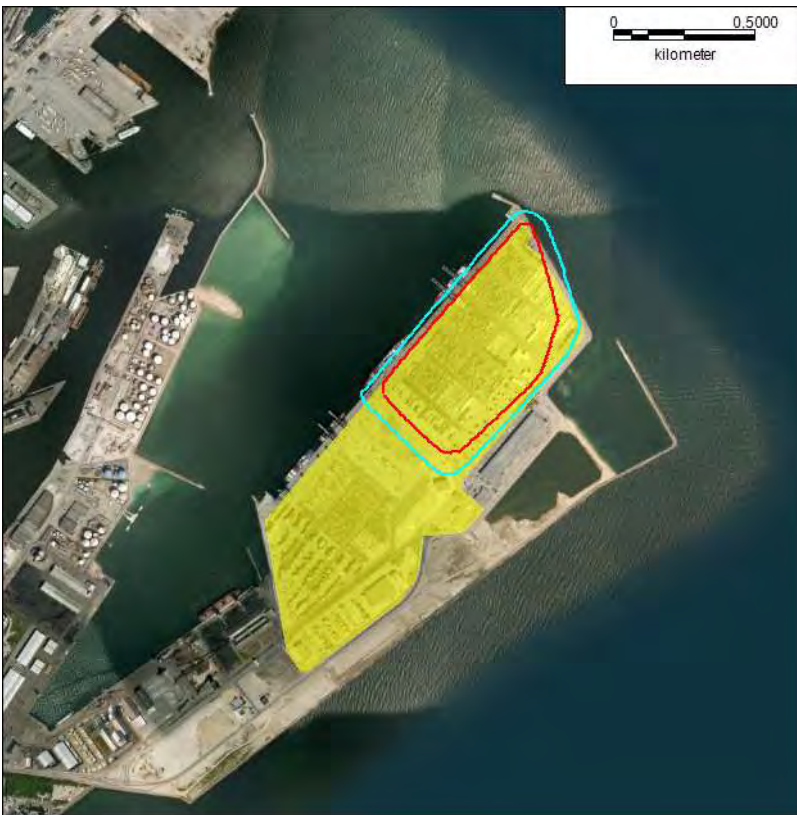
Figur 3: Kortbilag med angivelse af sikkerhedszonen, svarende til en isorisikokurve på 1 \cdot 10^{-6} pr. år (blå kurve). Den røde kurve svarer til en isorisikokurve på 1 \cdot 10^{-5} pr. år
