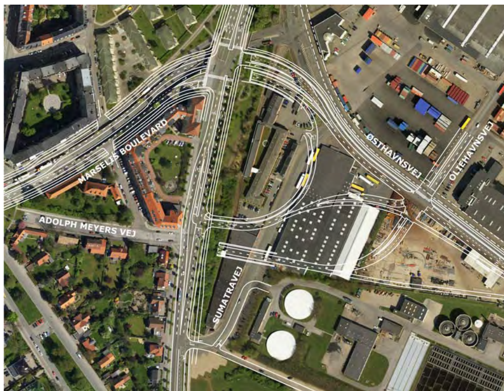
Figur 10.7 Principudformning af løsning med delte tunnelrør ved havnetilslutning.
