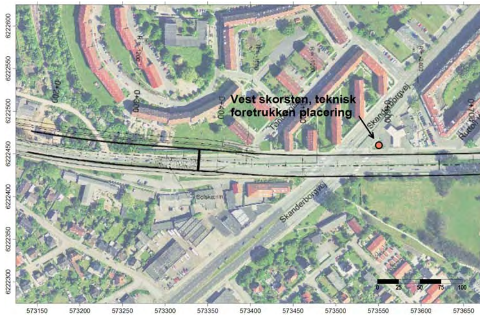
Figur 8.19 Placering af ventilationskorsten for vestgående tunnelrør.
