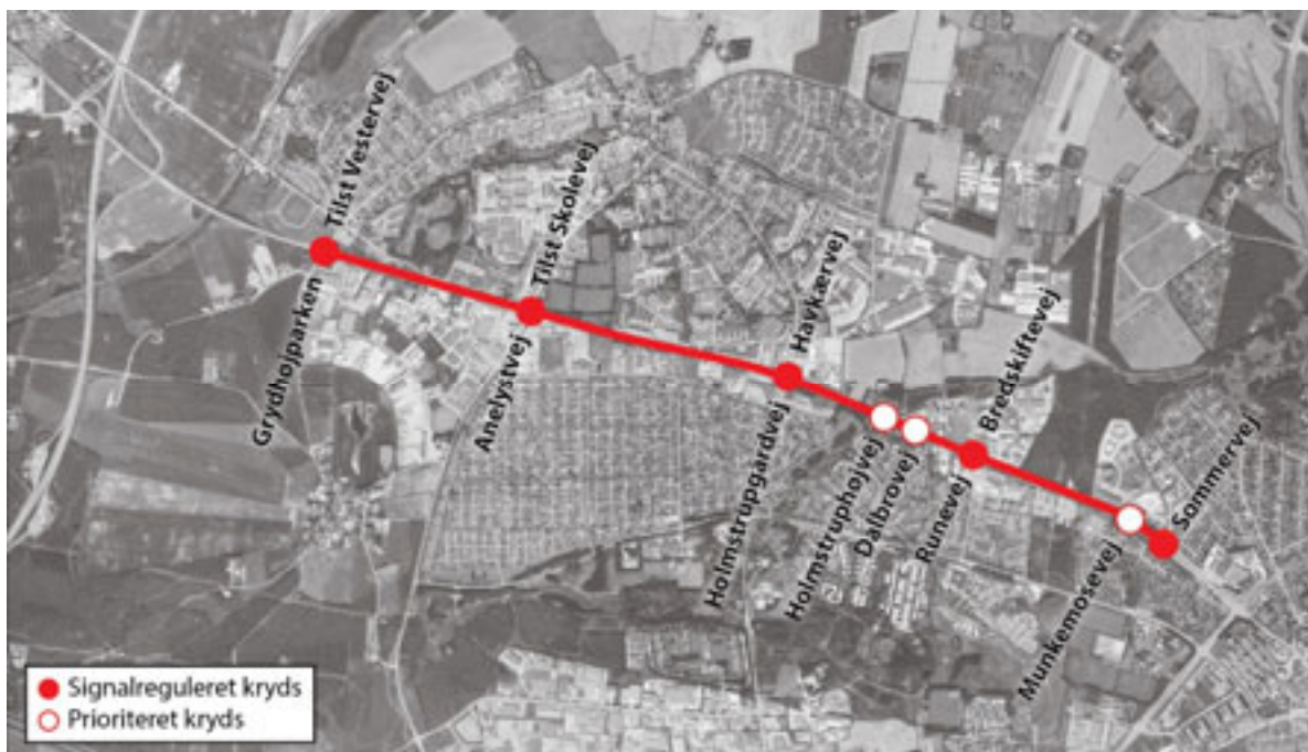
Figur 3.3 Den aktuelle del af Viborgvej, der påtænkes udbygget fra to til fire spor.
