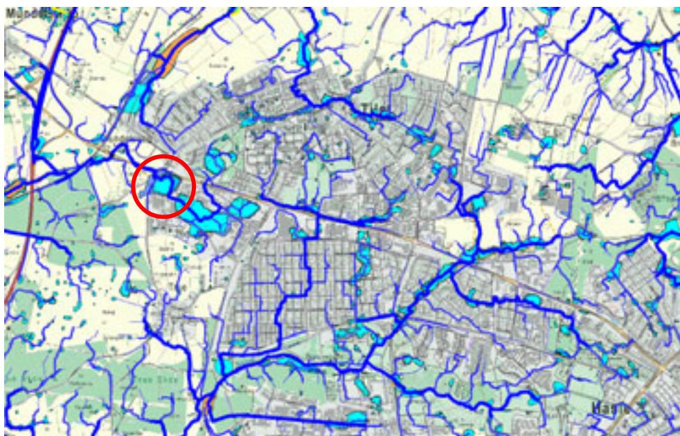
Figur 10.6 Screening for strømningsveje ved max nedbør (opland >1 ha) SCALGO.
