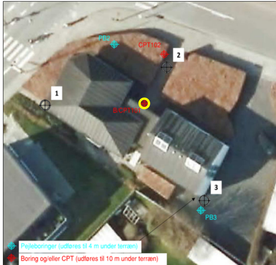
Figur A-2 Den undersøgte grund. Pumpeboringen, B/CPT 101, er markeret med gul cirkel.
