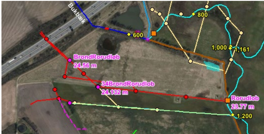
Figur 7: Opmåling af udløbskoter i brønde på drænsystemet under E45.
