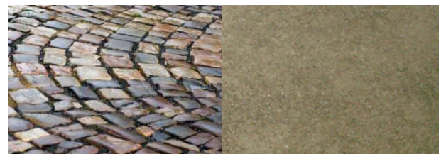
CHAUSSÉSTEN I GRANIT OG GRUS
