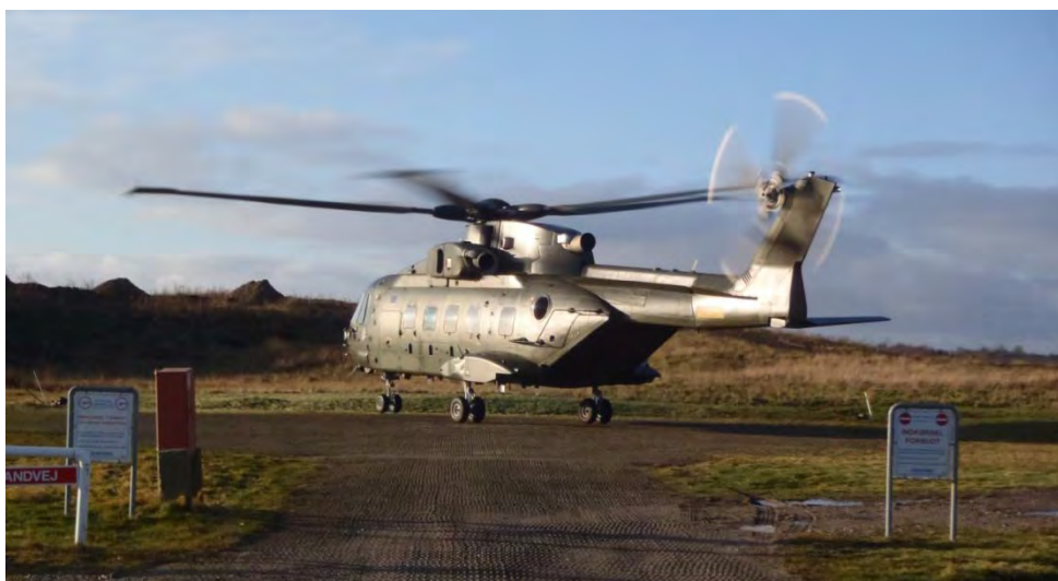
Figur 1-2: Forsvarets redningshelikopter (model: EH101, vægt: ca. 15.800 kg, længde: ca. 23 m).
