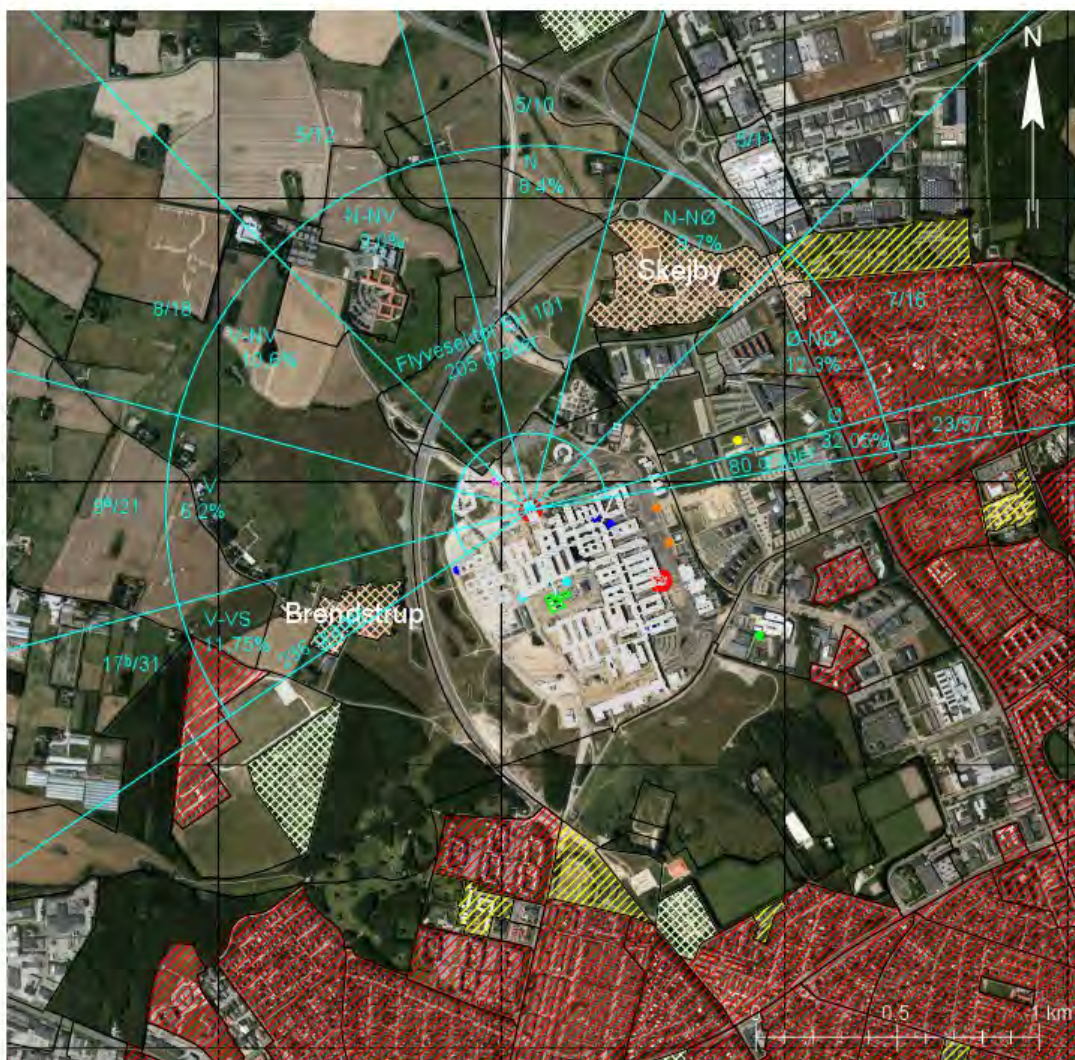
Figur 6-8. Kort over fordeling af indflyvninger (angivet i %) i flyvej 1 i forhold til vindrosens vindsektorer.
