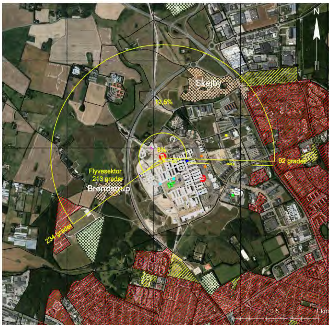
Figur 3-12. Kort over hovedforslag (flyvevej 4) for AW 139's flyveveje til heliport H1.
