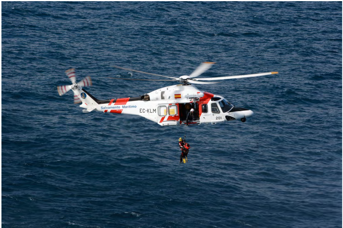
Figur 3-2. Lægehelikopter AW 139 under udførelse af søredning. AW 139 har en maks. vægt på 6.800 kg og totallængde på 16,66 m.
