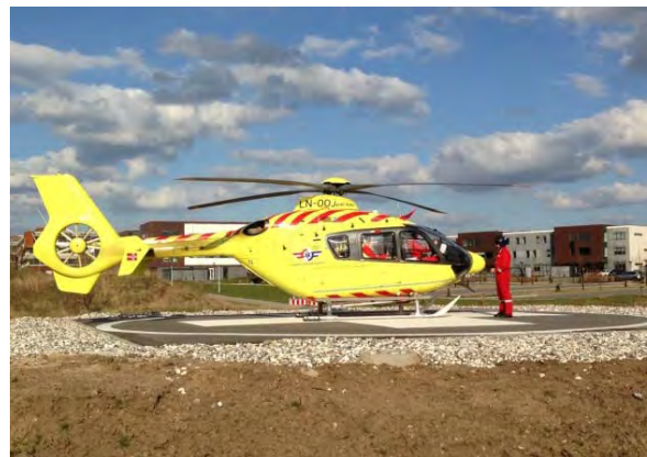
Figur 1-4. Nuværende lægehelikopter (model: EC135, vægt: ca. 3.000 kg, længde: ca. 12 m).
