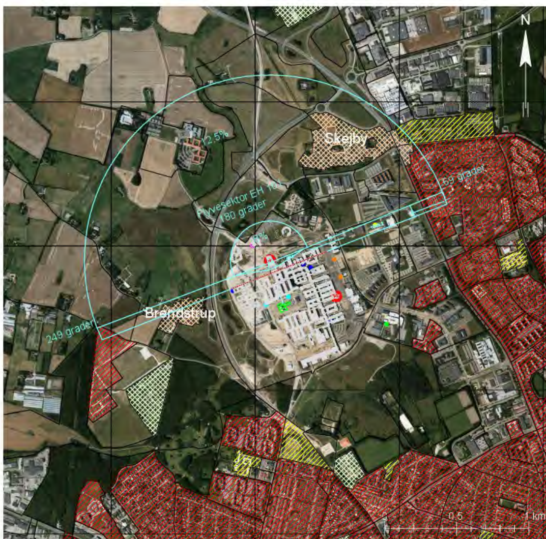
Figur 3-19. Kort over alternativ 1 (flyvevej 2) for EH 101's flyvevej til heliport H1.
