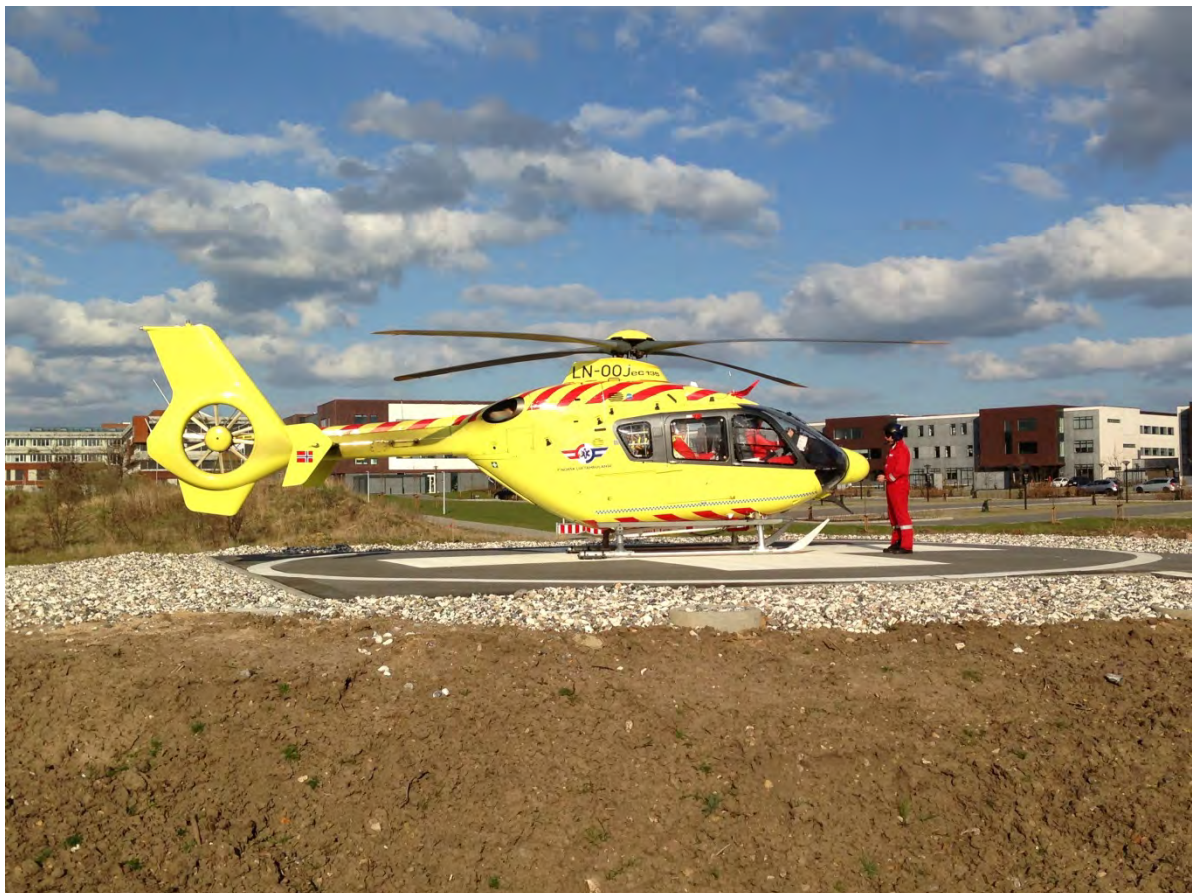
Figur 3-3. Lægehelikopter EC 135 ved midlertidig heliport ved Aarhus Universitetshospital. EC 135 har en maks. vægt på ca 3.000 kg og totallængde på 12,16 m.
