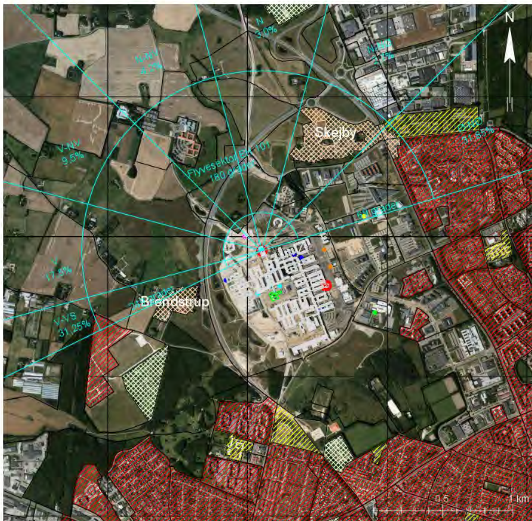
Figur 6-12. Kort over fordeling af starter (angivet i %) i flyvej 2 i forhold til vindrosens vindsektorer.
