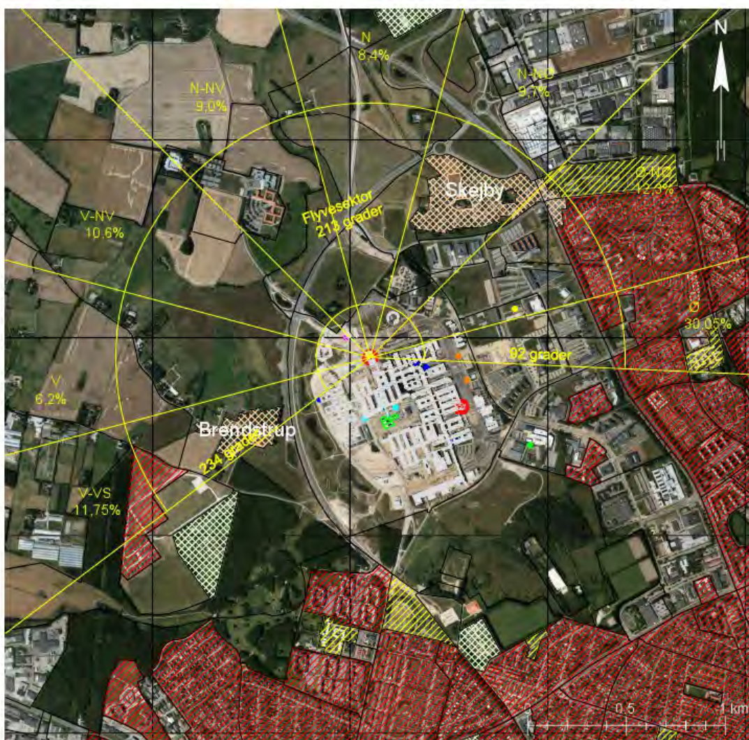
Figur 6-15. Kort over fordeling af indflyvninger (angivet i %) i flyvej 4 i forhold til vindrosens vindsektorer.
