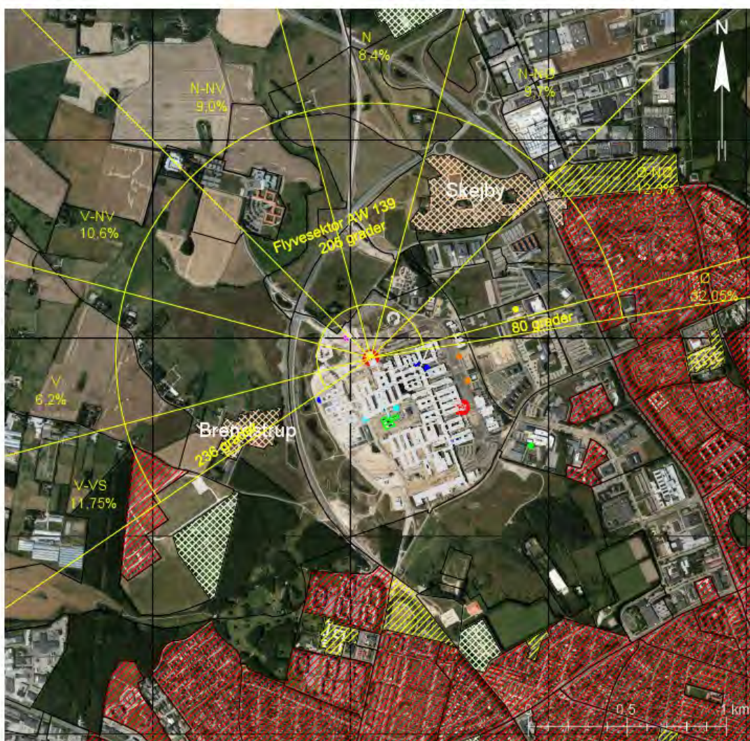
Figur 6-18. Kort over fordeling af indflyvninger (angivet i %) i flyvej 5 i forhold til vindrosens vindsektorer.
