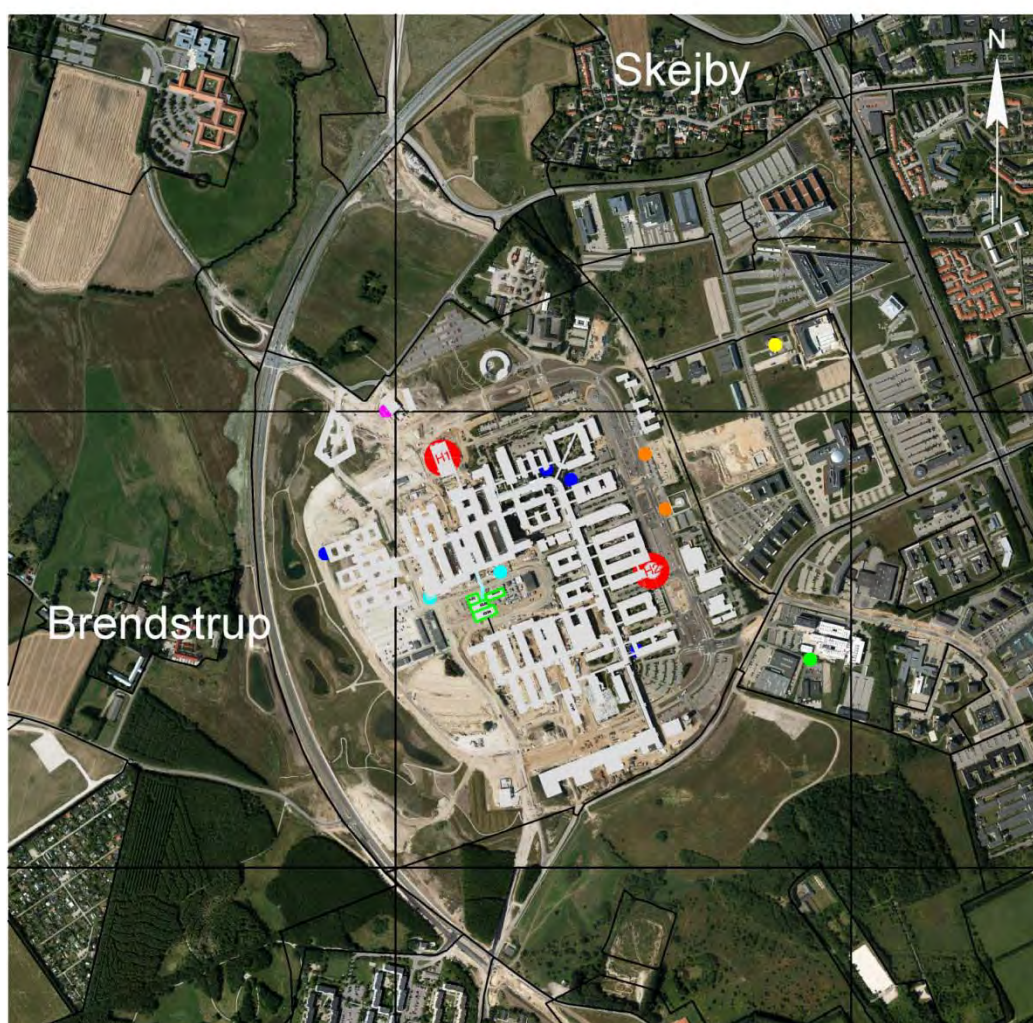
Figur 1-5. Placering af hævede helikopterlandingspladser ved akutcentret (Heliport H1) og hjertecentret (Heliport H2). Andre placeringer har været overvejet, men der er ikke oplagte alternative placeringer af landingspladserne. Endvidere vil det være lægefagligt uhensigtsmæssigt, hvis det ikke er muligt at lande tæt på operationsstuerne.
