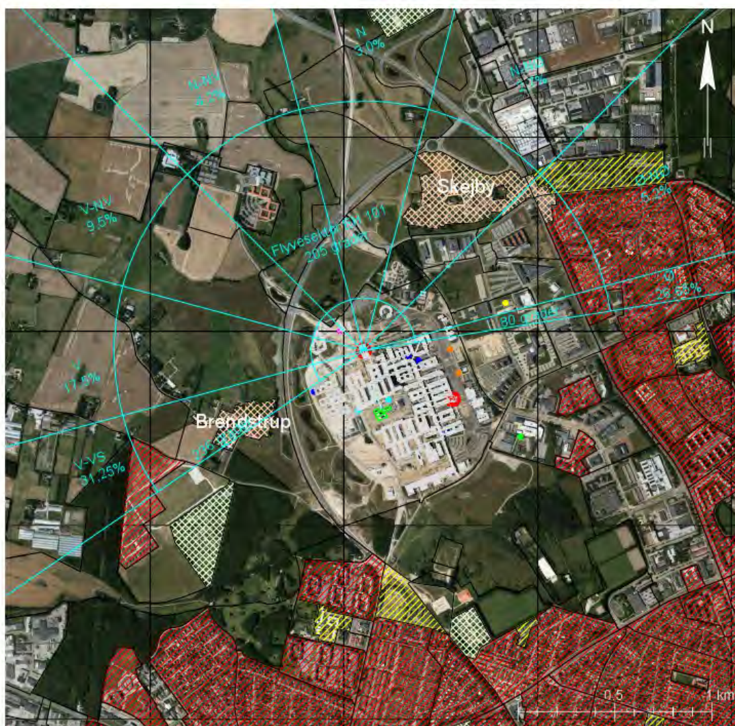
Figur 6-9. Kort over fordeling af starter (angivet i %) i flyvej 1 i forhold til vindrosens vindsektorer.
